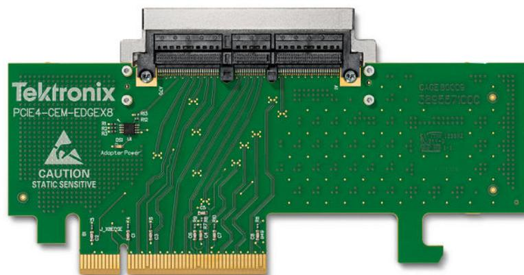
Figure 3: PCIe 4.0 x8 CEM Edge adapter
