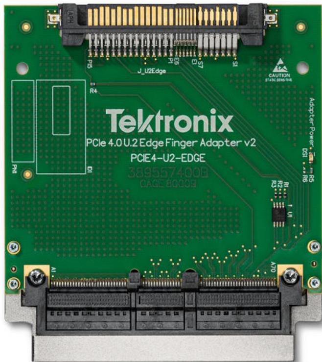
Figure 9: PCIe 4.0 U.2 Edge adapter
