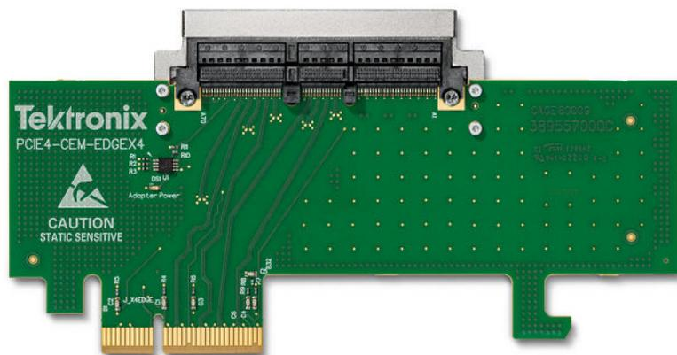
Figure 2: PCIe 4.0 x4 CEM Edge adapter
