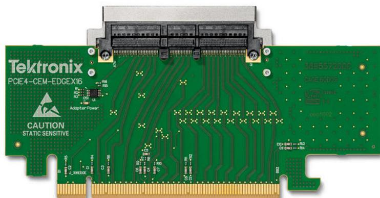
Figure 4: PCIe 4.0 x16 CEM Edge adapter
